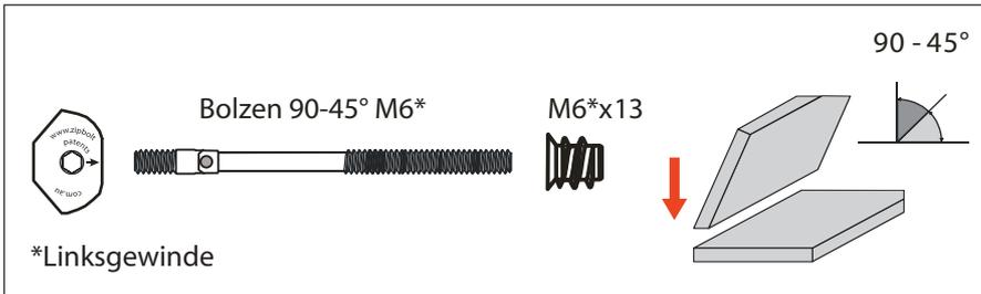
\*Eindrehen der Bolzen entgegen Uhrzeigersinn (Linksgewinde), damit der Verbinder wie gewohnt im Uhrzeigersinn angezogen werden kann.
