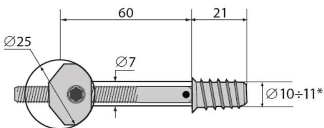
\* диаметр отверстия в зависимости от твердости древесины может меняться от 10 до 11 мм
