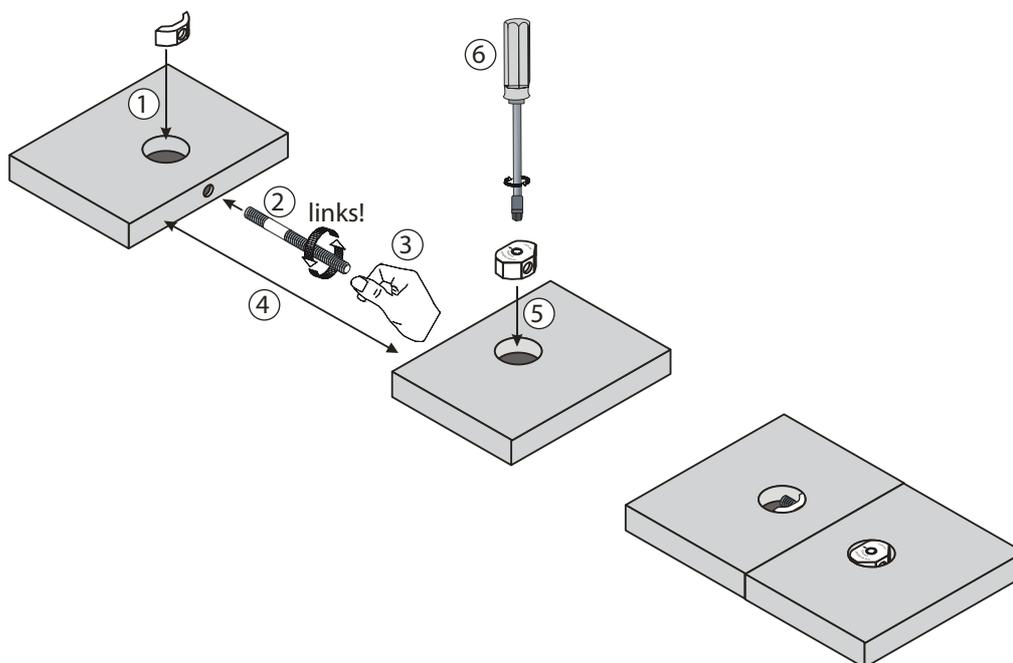
Arbeitsschritte bei horizontaler Plattenverbindung mit Nut/Schlitz (z.B. Arbeitsplatten in der Küche)
